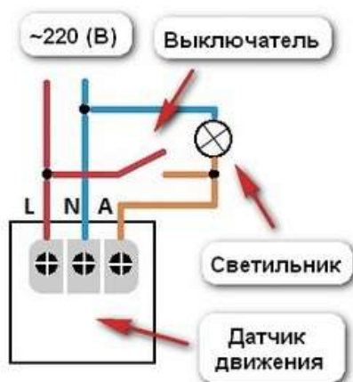
Рис. 2. Схема подключения датчика движения светодиодной ленты (второй вариант)
